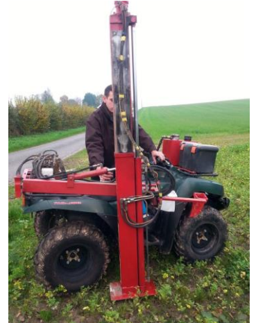
Tarière montée sur Quad
